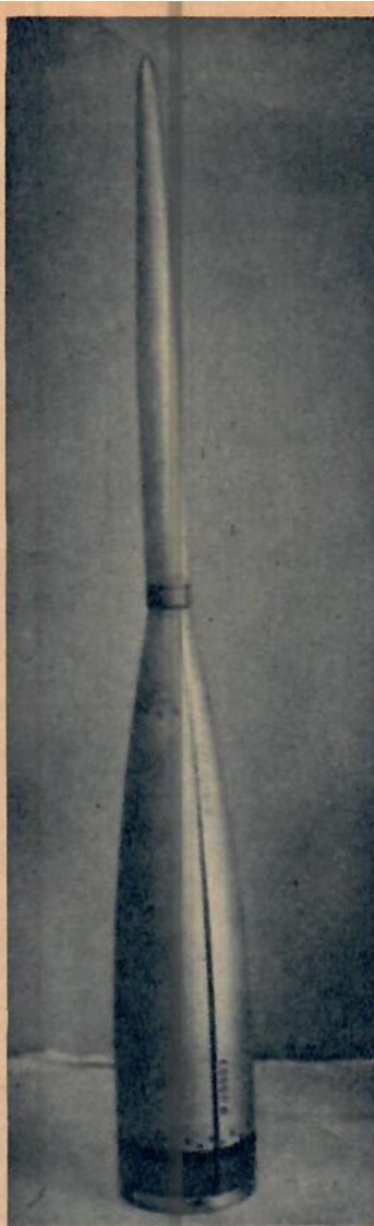
Ovan en bild på noskonen till en rysk forskningsraket. Instrumenten täcks av en konisk skyddsmantel.
