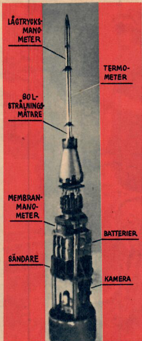
Ovan en bild på noskonen till en rysk forskningsraket. Instrumenten täcks av en konisk skyddsmantel.
