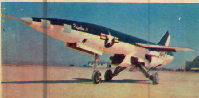
Bilden ovan visar de tre första Regulus II-robotarna. Bilden nedan: Den nya roboten har infällbart landningsställ. Roboten kan landa som ett flygplan och sedan starta på nytt för nya provflyningar.
