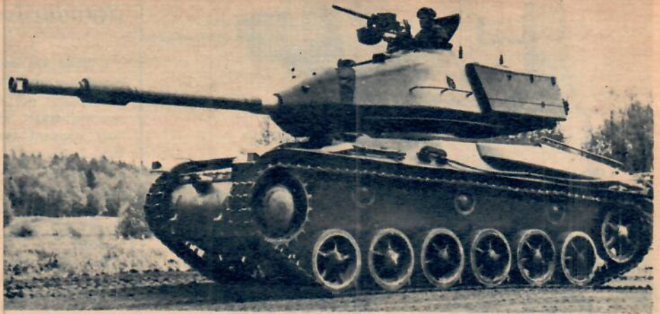
Vad som främst skiljer stridsvagn 74, ovan, från 42:an, nedan t. v., är det nya, slätare tornet med det långa kanonröret. Tornet har elektrisk och optisk utrustning liknande Centurions. Andra nyheter är bredare band och starkare motorer. I eldställning, nedan t. h., smälter 74:an väl in i terrängen.
