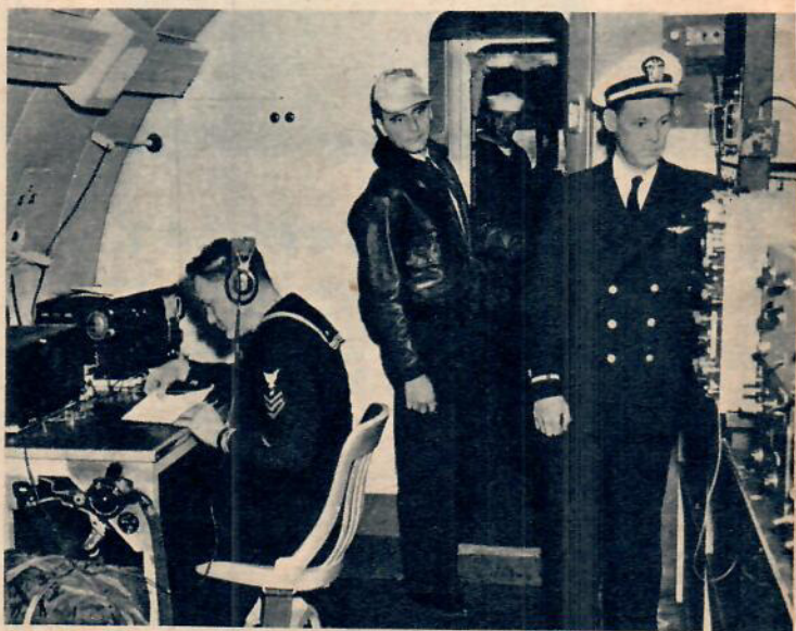
Här är en interiör från det flygande laboratoriet. Under flygningen inregistrerar elektronikinstrumenten de data om andning och hjärtverksamhet, som överförs från de sändare som fästs vid försöksflygarens kropp.
