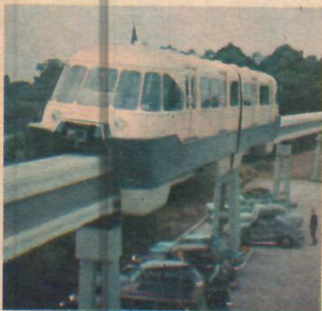
Alweg-tåget i full skala är 22 meter långt och kan befördra 200 passagerare. Försökståget är byggt i två »celler», 11 m långa och 3 m breda.
