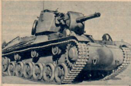
Vad som främst skiljer stridsvagn 74, ovan, från 42:an, nedan t. v., är det nya, slätare tornet med det långa kanonröret. Tornet har elektrisk och optisk utrustning liknande Centurions. Andra nyheter är bredare band och starkare motorer. I eldställning, nedan t. h., smälter 74:an väl in i terrängen.
