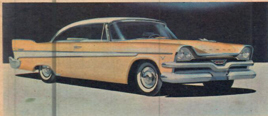
Dodge Kingsway har en V 8:a på 167 hästar under huven. Visserligen har den dubbla strålkastare under skärmössorna men den ena är parkeringsstrålkastare. Torsionsfjädring fram.
