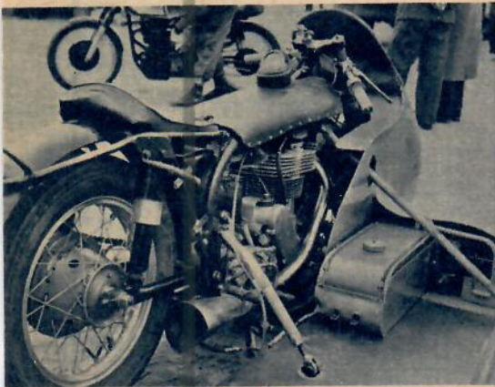
Grossmanns 500 cm 3 Norton visade upp en fiffig detalj vid tankplaceringen. Den står i sidvagnen.
