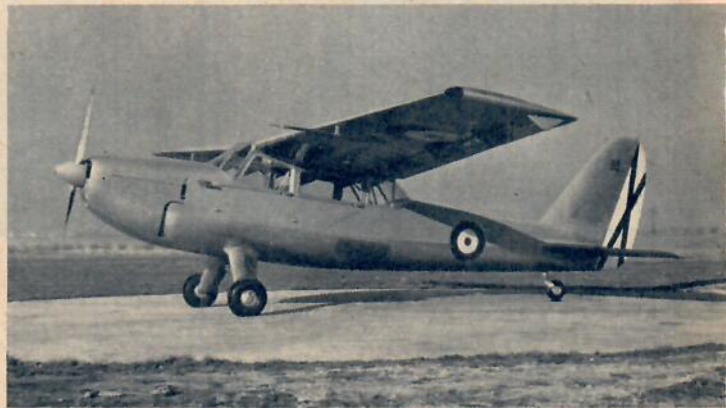
AISA 1-11B (bilden ovan) är ett lågvingat plan med två platser sida vid sida. Gör 172 km/t med en 90 hk Continental-motor. Bilden nedan visar den spanska flygindustrins trumfkort: det högvingade, fyrsitsiga helmetallplanet AISA AVD-12C Dewoitine, som gör 278 km/t maxfart.
