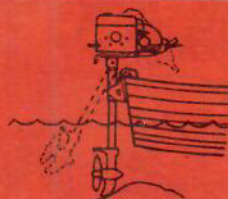
Grundstötsäker — räddar propellern vid grundstötning
