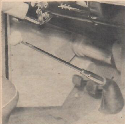
Växelspaken på Volvo med Amazonmotorn har delats i två delar och förbundits med en gummibussning för att dämpa motorvibrationerna.
