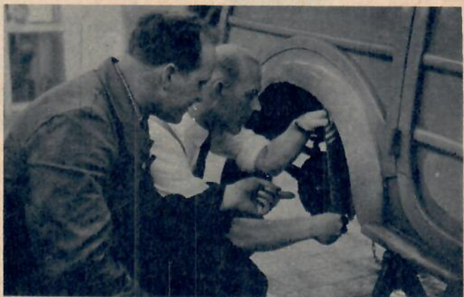
Det där ser ju riktigt fint ut, säger verkmästare Gunnar Andersson till Sigvard Rosén, som filar på de nymonterade bromsbackarna för passning.
