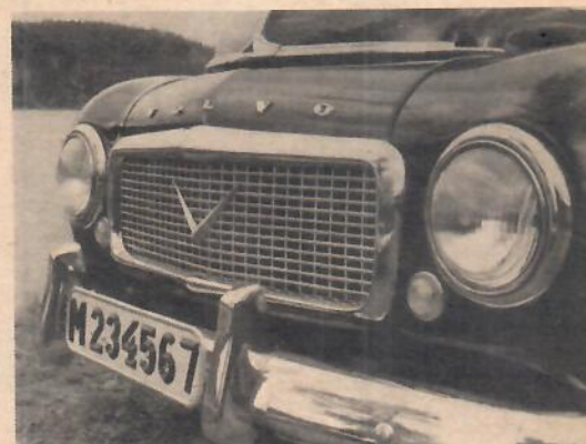
Frontalt sett ligger nyheterna i fronten med det gyllene V-tecknet. Det betyder inte V-8:a! Blinkersn har flyttats nedanför strålkastarna.
