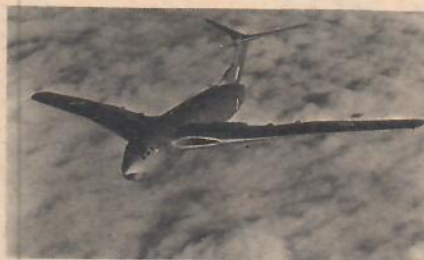
Handley Page Victor har fyra reamotorer och toppfarten ligger strax under Mach 1.
