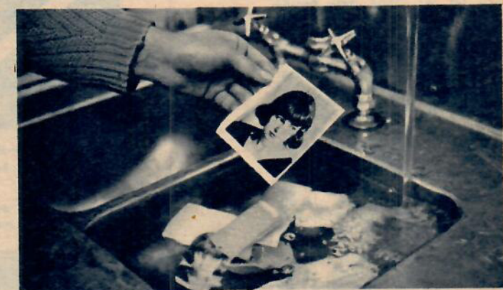
Bilderna måste hållas i rörelse vid sköljningen, så att de inte klumpar ihop sig. Otillräcklig sköljning ger lätt upphov till bruna fläckar (ovan). Efter sköljningen valsas bilderna fast på en glansplåt med en gummivals. Bilderna lossnar från glansplåten när de är torra (nedan).
