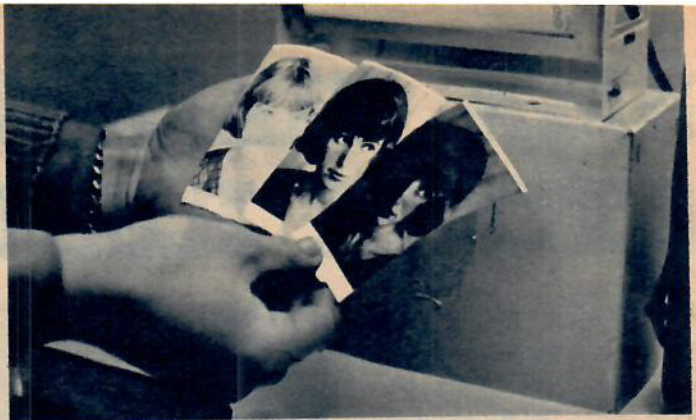
Exponeringstiden bestämmer man bäst med hjälp av provremсор. Proven under lyktan visar fr. v. för kort, lagom och för lång exponeringstid.
