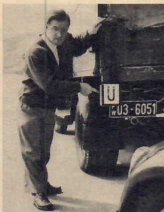
Här är en ny tysk giv för säkrare omkörning. Baklyktan visar ett stort grönt »ü» då sikten är klar och omkörning kan ske utan risk.
