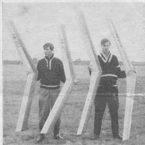
De två schweizarna Graaf med sina linjerena modeller. Dessa "vingar" kunde ej trimmas med anfallsvinkel utan enbart genom förflyttning av tyngdpunkten
