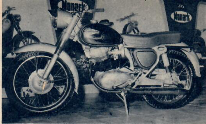
Monark har fått en 250 cm 3 NSU Max-motor med skjutstängsstyrda ventiler. Kombinationen verkar lyckad men NSU:s egen ram är mer avancerad.
