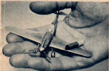
En av världens minsta elmotorer tillverkas av en tysk firma. Driver propellern på denna Messerschmitt-modell med 1.000 varv/minuten.
