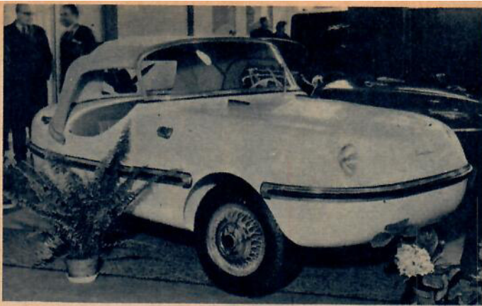
Belcar är en trehjulig schweizisk bil som debuterade på Genève-salongen. Den är helt av plast och har hydrauliska bromsar. Motorn, som är en Victoria tvåtakts 197 cm 3 motorcykelmotor, driver bakhjulet över en kedja.
