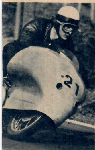
Det är stor skillnad på strömlinjekapslingen på BMW:n (t. v.) och Norton (t. h.) men maskinerna har trots samma effekt ungefär samma toppfart. BMW är tyngre.
