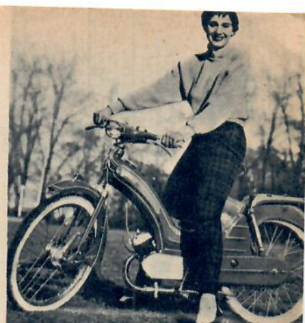
Sista versionen av populära Victoria Vicky har bl. a. kapslad bakkedja, svängarmsfjädring bak och ramtank.
