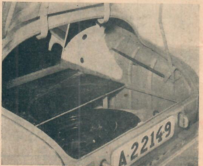
Bagageutrymmet är relativt stort och mycket väldisponerat med helt plant golv. Reservhjulet ryms i ett fack under bagagerummets golv.
