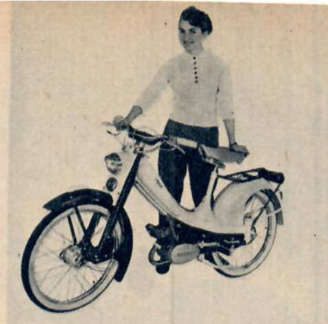
I högsta grad välsvarvad är också Achilles-Capri med ram, styrstång och framgaffel i pressad plåt. Bensintanken är inbyggd i ramen. Sachs 50 cm 3 .
