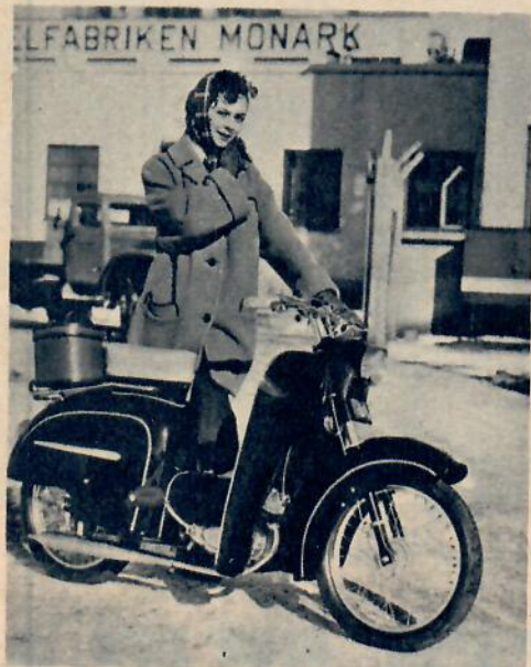
Monarks tvåväxlade mopedscooter har kickstart och synnerligen väldämpad Pilotmotor på 50 cm 3 . Bakfjädringen av svängarmstyp är gummiupphängd.
