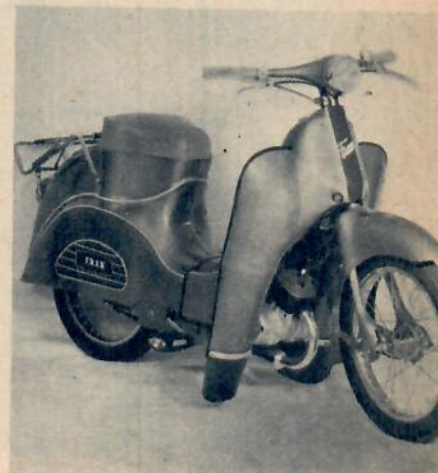
Frams mopedscooter har tvåväxlad, handstartad Victoriamotor under det moderna skalet. Priset är omkr. 1.200 kr.
