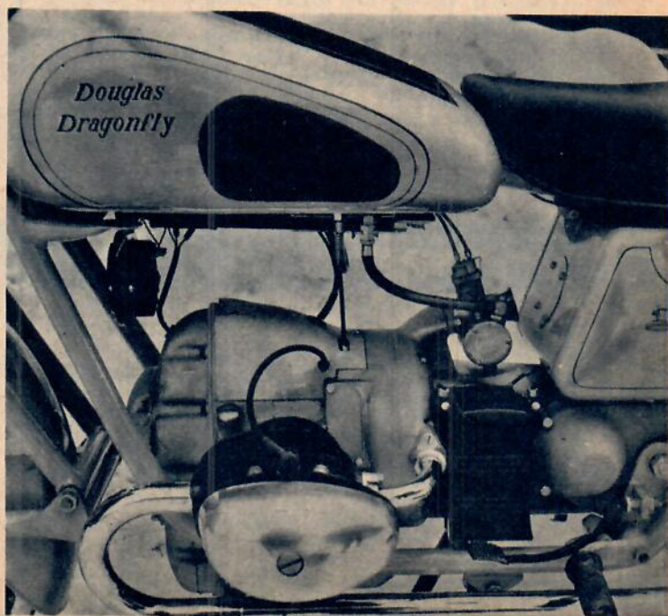
Inget försök har gjorts att kapsla in vare sig förgasare eller batteri. Fördelen med detta är att båda är synnerligen lätta att komma åt.
