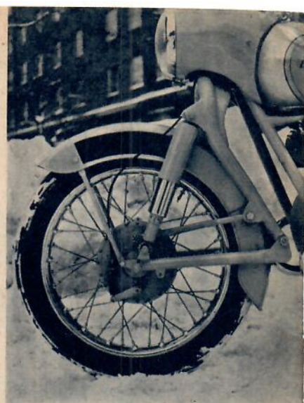
Earles-framgaffeln med kraftig stötdämpare är delvis inbyggd i strålkastaren, vars kapsling omsluter hela styrhuvudet. Fjädringen är bra.
