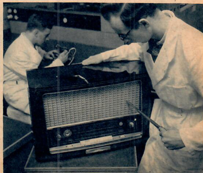
Ing. Kurt Lundgren kontrollerar att lådans framsida är hållbar. Det krokiga »fingret» får inte nå spänning genom baksidans hål.
