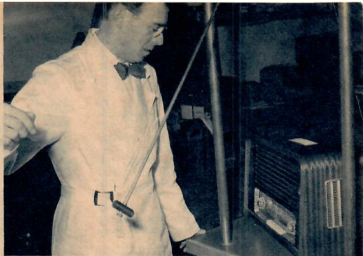
Med pendelhammaren provar ing. Reinhold Nilsson radions rattar. De måste vara ett hållbart skydd på den ofta strömförande axeln.
