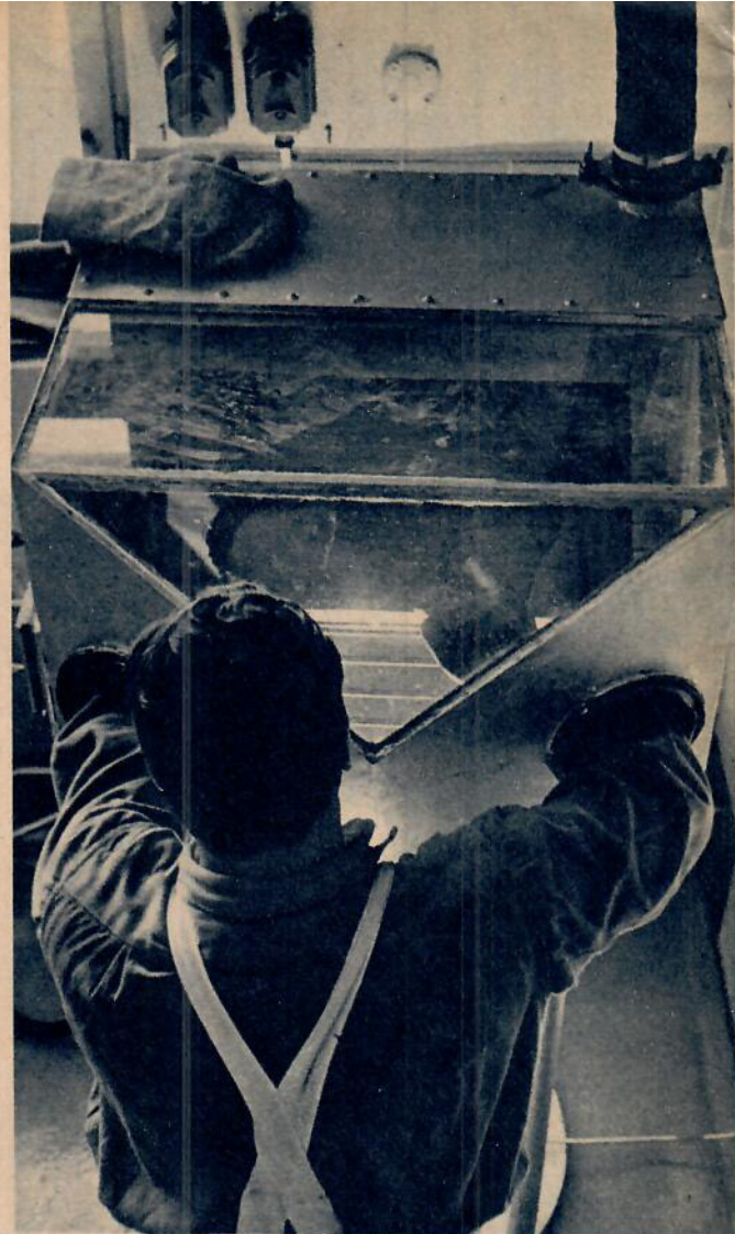
Stig Lövstrand knädar torkad uranoxid i dryboxen. Den lufttåta lådan och undertryck ger pålitligt skydd mot giftigt urandamm.
