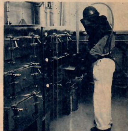
Uranoxiden torkas i en vanlig bakugn. Stig Lövstrand bär lufthjälm som skydd.
