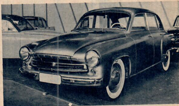
F. d. BMW-fabriken i Eisenach, som numera heter EMW, spelar ut det här trumfkortet som har en trecylindrig tvåtaktsmotor under huven.
