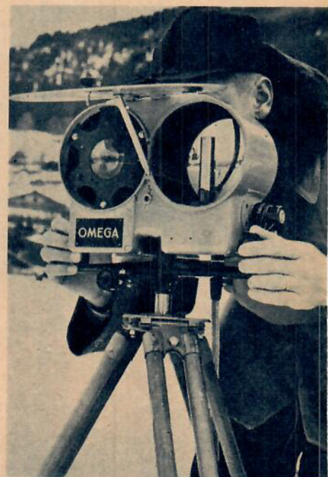
Den fotoelektriska cellens snabba reaktion ger absolut säkerhet vid all slags tidtagning.
