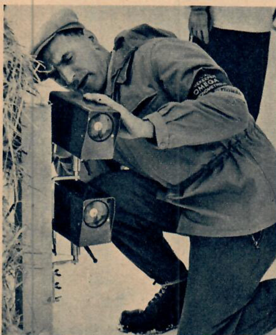
I samma ögonblick som en olympier skar mållinjen gick en impuls från fotocellerna (se bilden) till Omegas tidtagarur.
