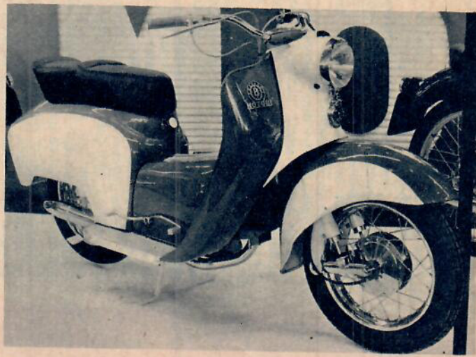
En ny stjärna på skoterfirmamentet är Motobi, som under sitt plåtskal döljer en encylindrig 175 kubiks toppventilmotor på 8,5 hk vid 6.800 v/m.
