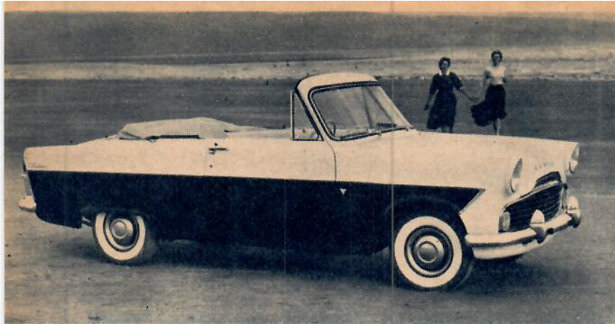
En elegant nykomling i den engelska Fordfamiljen är Ford Zodiac cabriolet, som har elmanövrerad sufflett. Vagnen kan fås med helautomatisk växellåda.
