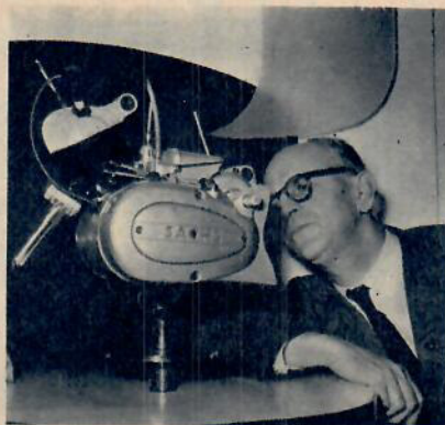
Sachs nya mopedmotor på 50 cm 3 är utrustad med hela tre växlar och granskas här i detalj.
