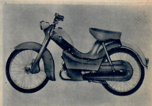
Nya Kreidler Amazone moped är synnerligen välformad. Styrstängskontrollerad 2-växlad låda.
