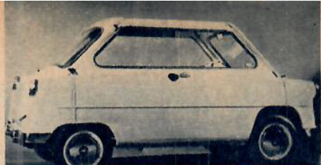
Zündapp Janus har övertagit Dorniers konstruktion med dörrar fram och bak och bakvänt säte.
