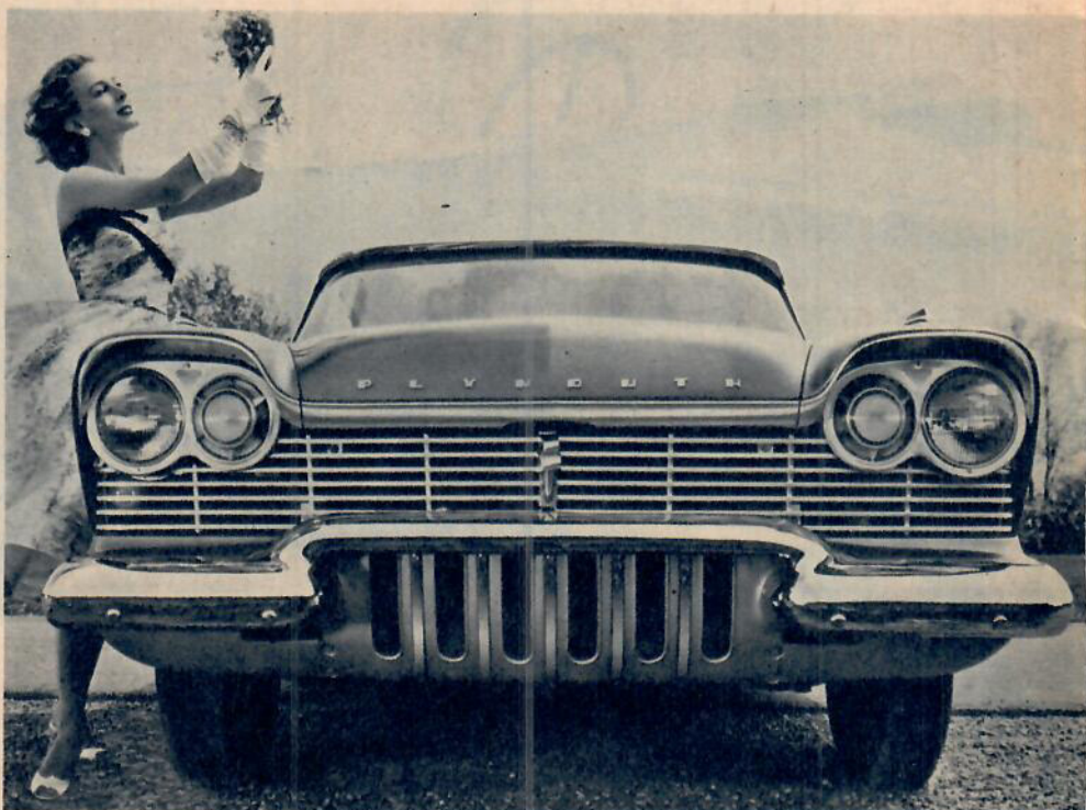
Två dollargrin 1957: övan Lincoln med fyra strålkastare fram. De har som synes placerats så att huvudstrålkastaren sitter överst. Plymouth 1957 däremot (bilden nedan) har lamporna fram vid sidan av varandra: strålkastarna ytterst och parkeringsljus och blinkers innanför. Största nyheten med Plymouth är att vagnen fått en helt ny typ av torsions-luftfjädring, som är mycket bekväm.
