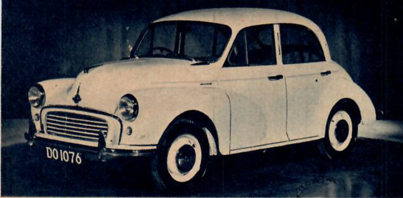
Det här bör bli en av marknadens snabbaste småvagnar: Morris Minor 1000 har 37 hk under huven och uppges kapabel till bortåt 130 km/t. Odelad vindruta, större bakruta och 950 cm 3 motor (kompr. 8,3) hör till nyheterna.
