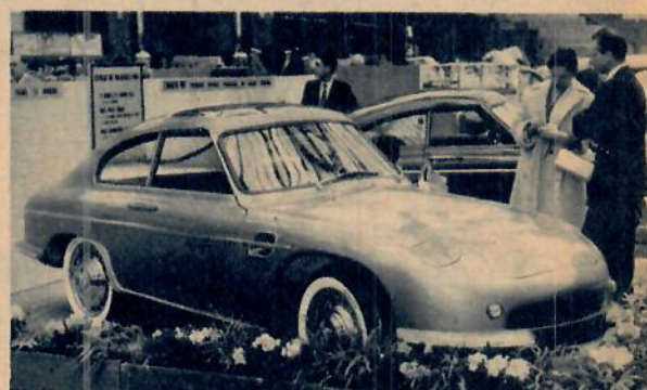
Deutsch-Bonnet hade som vanligt en representant med bland Salongens specialkarosser. Denna vagn har 850 cm 3 Panhardmotor, som bromsar ca 50 hk vid 5800 v/m.
