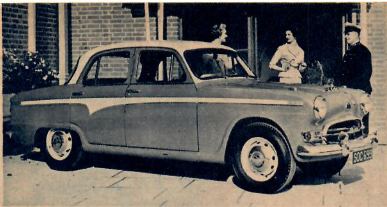
En positiv nyhet är den engelska Austin A 95, som har 92 hk under huven och kan levereras med automatisk kraftöverföring. Vagnen är sexsitsig. Den tidigare så utmärkande bulliga karossformen har försvunnit och vagnen har blivit större.
