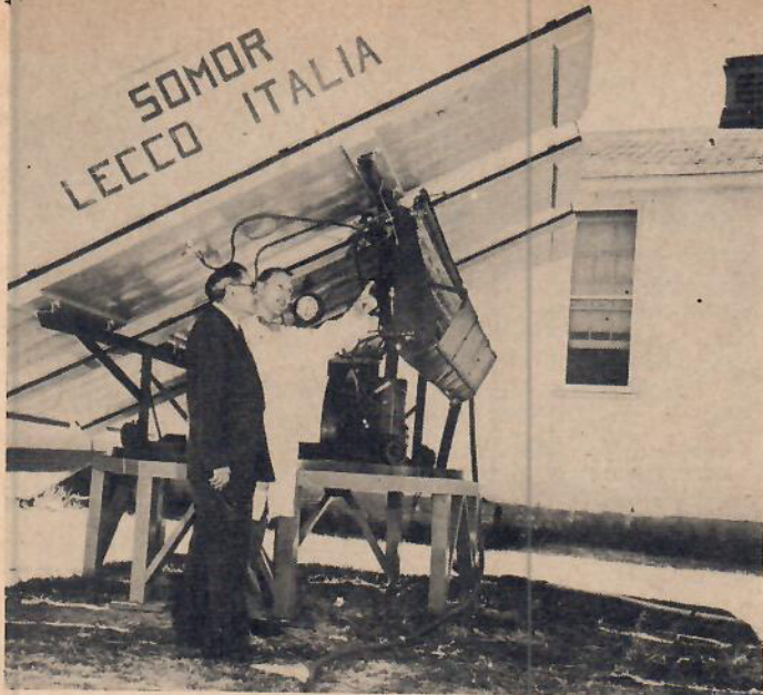
I detta aggregat förgasas svaveldioxid med solvärme och får sedan driva en pumpmotor. Det uppumpade vattnet kylar åter dioxiden i kondensatorn.
