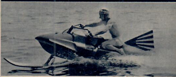
Chafee Ski heter en amerikansk vattenskoter som skidar fram över vatten på två vattenskidor placerade i linje bakom varandra. Gör 80 km/t.
