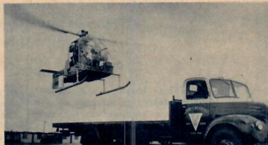
Faireys reahelikopter nöjer sig med ett lastbilsflak som »flygfält». Motorn är en Turbomeca Palouster 500.
