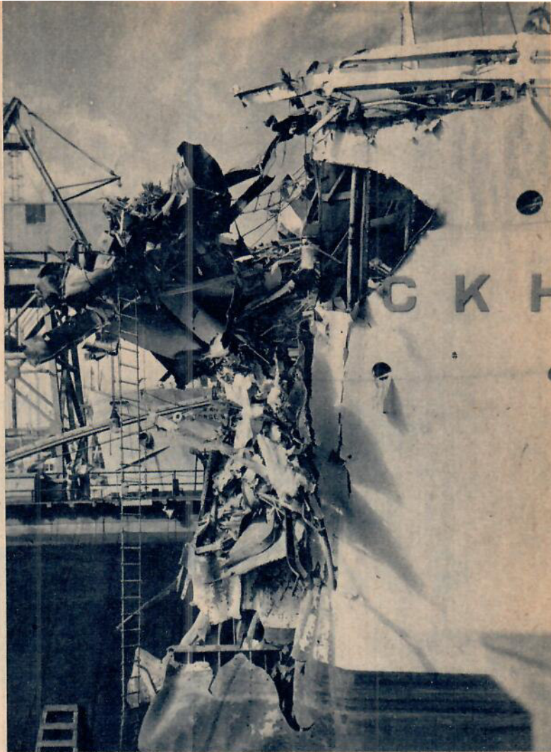
Stockholm fick svåra skador. 23 m av fören förstördes vid kollisionen.
