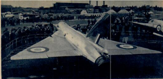
Fairey Delta 2 håller det absoluta världsrekordet med 1.822 km/t. Planet har reglerbar utblåsningsskon. Över konen: bromsfällskärmen.
