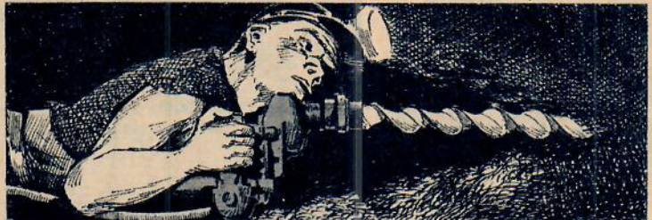
Elektrisk gruvborrning i trånga schakt
