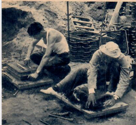
Företaget Suez Contractors arbetar fortfarande för britterna vid Suez. Här gjuter billig egyptisk arbetskraft maskindelar i sandformar.
