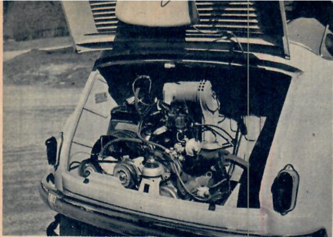
Fiat Multipla har en fyrcylindrig fyrtaktsmotor som sitter baktill. Motorn har slagvolymen 633 cm 3 och utvecklar 21,5 hk vid 4.600 varv/min.
