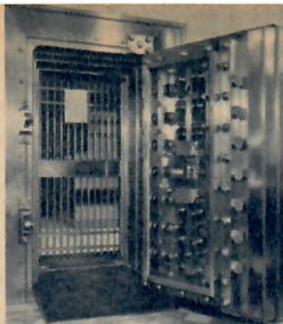
Denna dörr är försedd med 18 låskolvar, två upptill, två nertill och sju på vardera sidan.
