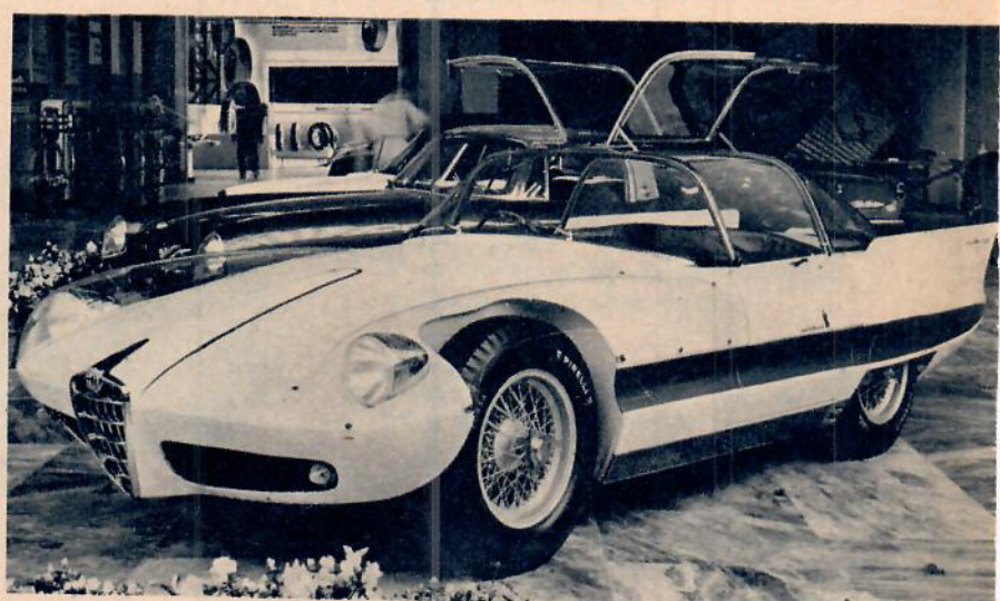
Super Flow kallar Farina sitt senaste specialkarosseri på Alfa Romeo Disco Volante (sexylindrig motor, 3,5 liter). Dörrarna öppnas som på Mercedes 300 SL. Främre stänkskärmarnas överdelar är gjorda som genomskinliga kåpor av plast vilka även döljer strålkastarna.
