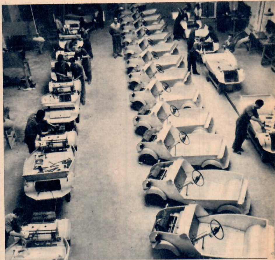
I fabriken i San Adrian de Besos tillverkas 15 Biscuters om dagen. Motorn fram och ett litet bagageutrymme bak. Plåten i hårdaluminium hela 2-3 mm tjock. Karossen väger 34 kg.
