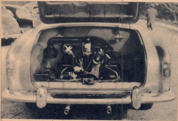
Motorn är den gamla pålitliga slitvargen från världssuccén Volkswagen. Den sitter längst bak och är lätt åtkomlig under den stora motorhuven.
