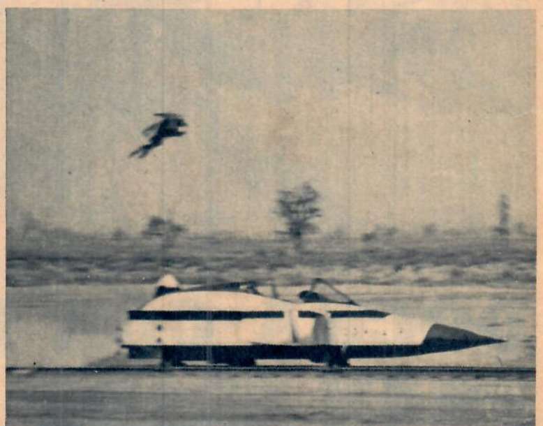
6 Raketsläden rusar vidare längs sin räls och farten hålls konstant genom en speciell motor. Katapultstolen fortsätter uppåt.
