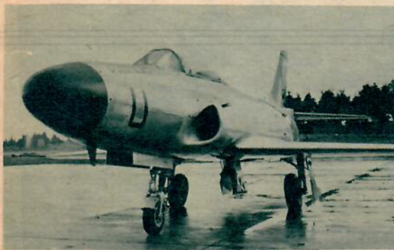
Luftintagen till rea-aggregatet ligger på kroppssidorna strax framför vingen vilket ger planet vissa likheter med bland annat Shooting Star.
