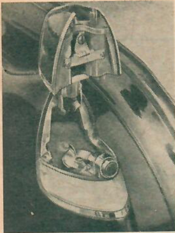
Genom att fälla upp vänstra körriktningsblinken i »fenan» kommer man åt bränslepåfyllningslocket.
