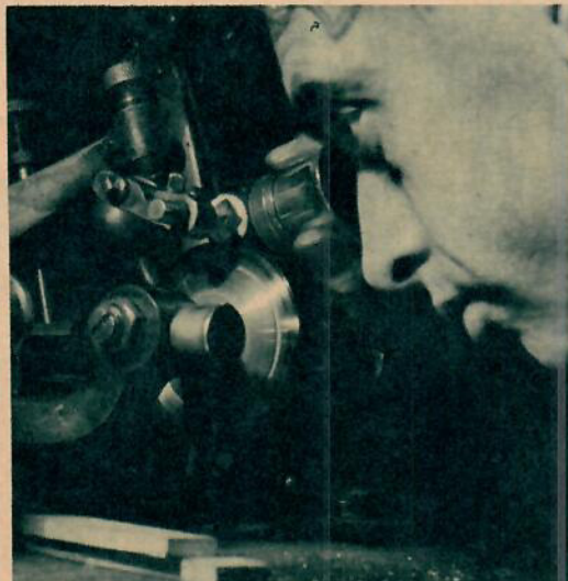
Att säga igenom en diamant tar sin rundliga tid. Den roterande bronsskivan har här efter flera timmar bara trängt halvannan millimeter in i diamanten.
