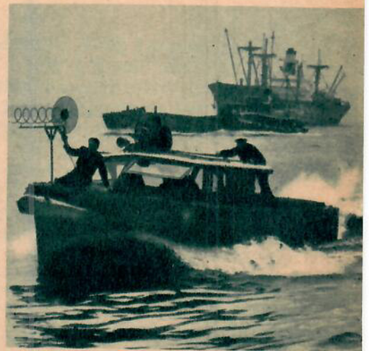
Även på sjön går jakten på de illegala radiosändarna. Spiralantennen används för lokalisering av högfrekventa sändningar.
