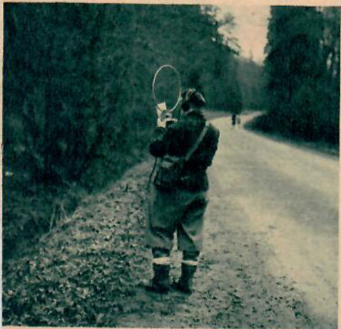
Man använder det långvägigaste amatörbandet, 80 meter, eftersom radiovågorna har större förmåga att utbreda sig efter marken, dämpas mindre, ju längre de är.
