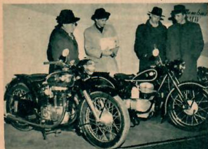
Marknadens flottaste 350:a, Horex, med kapslad bakkedja bl. a. samt den minsta medlemmen i den kardandrivna BMW-familjen.
