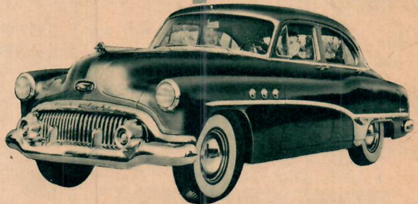
Buick Serie 40 Special har fått en mer sansad kylargrill än tidigare. De öppna, ovala hälen på sidorna har nu blivit runda igen och försetts med en liten grill. Samtliga Buickvagnar har i år försetts med en mot bakskärm svagt nedsvängd kromlist.
