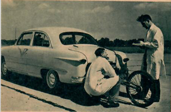
»Femte hjulet» är en noggrann elektrisk fart- och vägmätare. Den fästes bakpå vagnen vid accelerationsprov, bromsningsprov och vid kontroll av toppfarten.
