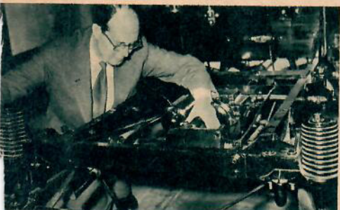
Tror ni att svansmotorer i bilar är en ny idé så tror ni alldeles fel. Den här lilla bilen är nämligen från 1900-talets första år — Orient heter den. En fläktkyld encylindrig motor driver direkt på bakhjulen via kedjor.
