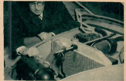
Den gamla trogna DKW-motorn har flyttats längre fram och fått en del nya finesser, bl. a. fallförgasare och en stor luftrenare.
