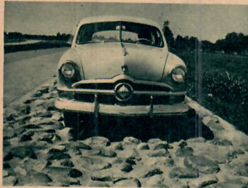
750 turer över den här kullerstensvägen anses motsvara 8.000 svenska miles körning. Koncentrerade prov är en av huvudprinciperna vid provbanorna hos Ford.
