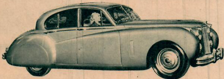
Långfärdsbilistens önskedröm, Jaguar Mark VII, är försedd med den välkända Super Sport-motorn. För att få bagageutrymmet så stort som möjligt har bensintanken delats med en halva på vardera sidan i kofferten. Varje tank har separat ledning.
