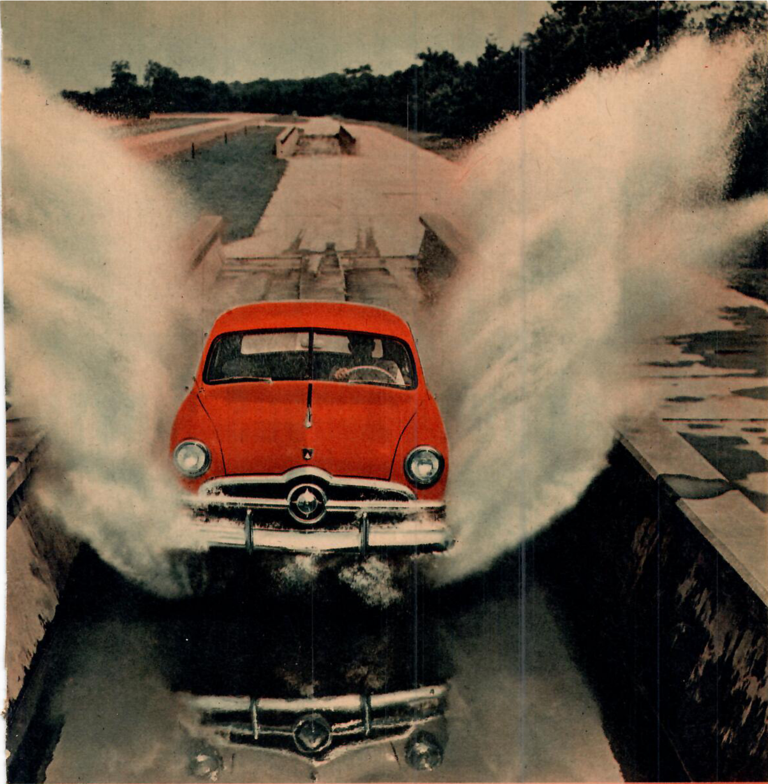
TMÄRKT KONTROLL PÅ ATT BROMSAR OCH TÄNDNING FORTFARANDE FUNGERAR OKLANDERLIGT ÄVEN EFTER GRUNDLIG DUSCH.
