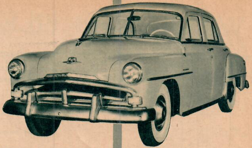
Plymouth Cranbrook 4-dörrars sedan har fått kompressionen på sin starka motor höjd till 7:1. Vindrutetorkarna är elektriska och självparkerande, kombinerat tändningslås och startknapp är andra nyheter. Det är gott om utrymme inne i vagnen.
