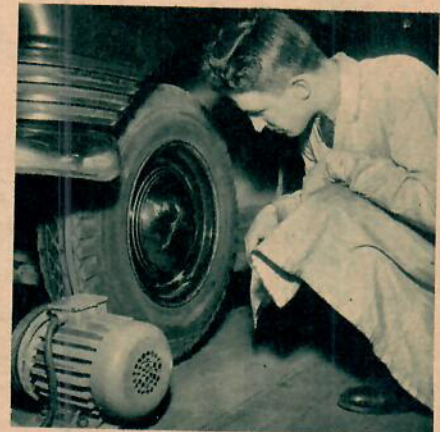
Hjulbalanseringen sker med hjälp av en remskiva. Övervakare är ing. Nils Hedman.
