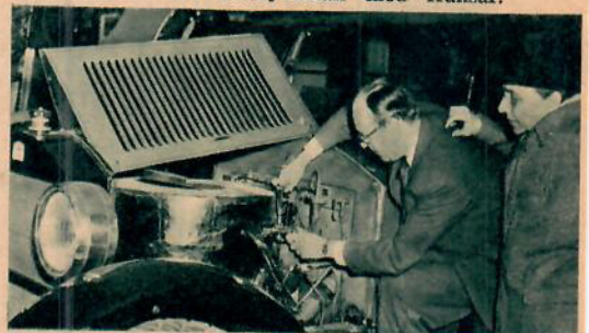
En Stanley ångbil från 1923. Ångpannan består av spirallindade rör som upphettas av en brännare. I dessa rör sprutas vatten in och förångas. Som sig bör är luftfartsinspektör Tord Angström (t. h.) synnerligen intresserad.
