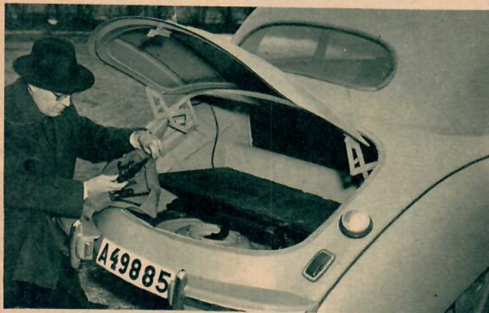
Bagageutrymmet är brett och djupt. Tack vare den styva bakhjulsfjädringen behöver man inte riskera att fjädrarna slår i botten eller att vagnen blir svajig om lastkapaciteten utnyttjas för fullt.
