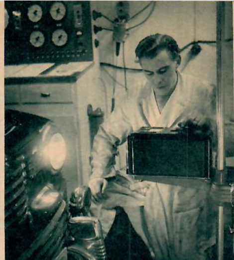
Strålkastarnas inställning i höjd- och sidled samt ljusstyrkan mäts här av Björn Dovrell. På 30 m kastades »värt» ljus 60 cm för högt.
