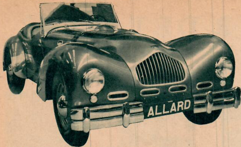
Allard är en extrem engelsk sportvagn. K 2-modellen är försedd med en special-trimrad Ford V-8 motor med cylindrarna i 90 grader, en volym på 3,62 liter och en effekt på 95 hk vid 3.800 varv/min. Tomvikten är 915 kg och toppfarten 160 km/t.
