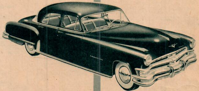
Den största och exklusivaste Chrysler-modellen är Imperial, som har kylargrill och stötfångare i en enhet, en tendens som alltmer gjort sig märkbar i USA. Med sin nya 180 hästars V-8 motor har vagnen en topphastighet på 170 km/t. Vikt ca 2.000 kg.
