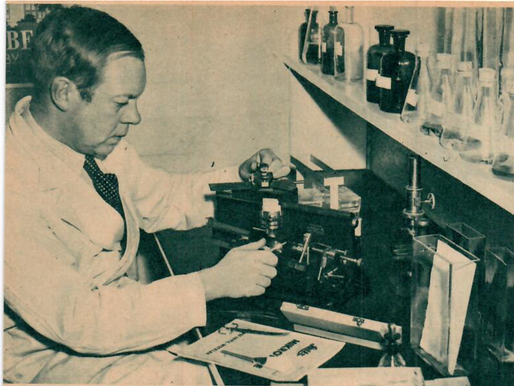
Tillverkning av mikroskopiska preparat sker i en s. k. mikrotom. Denna medger skärning av botaniska och zoologiska organ i snitt som mäter en tusen del av en millimeter. Preparatet ligger inbäddat i en paraffinkloss monterad i en kulle. Vid apparaten magister Nils Noréhn.
