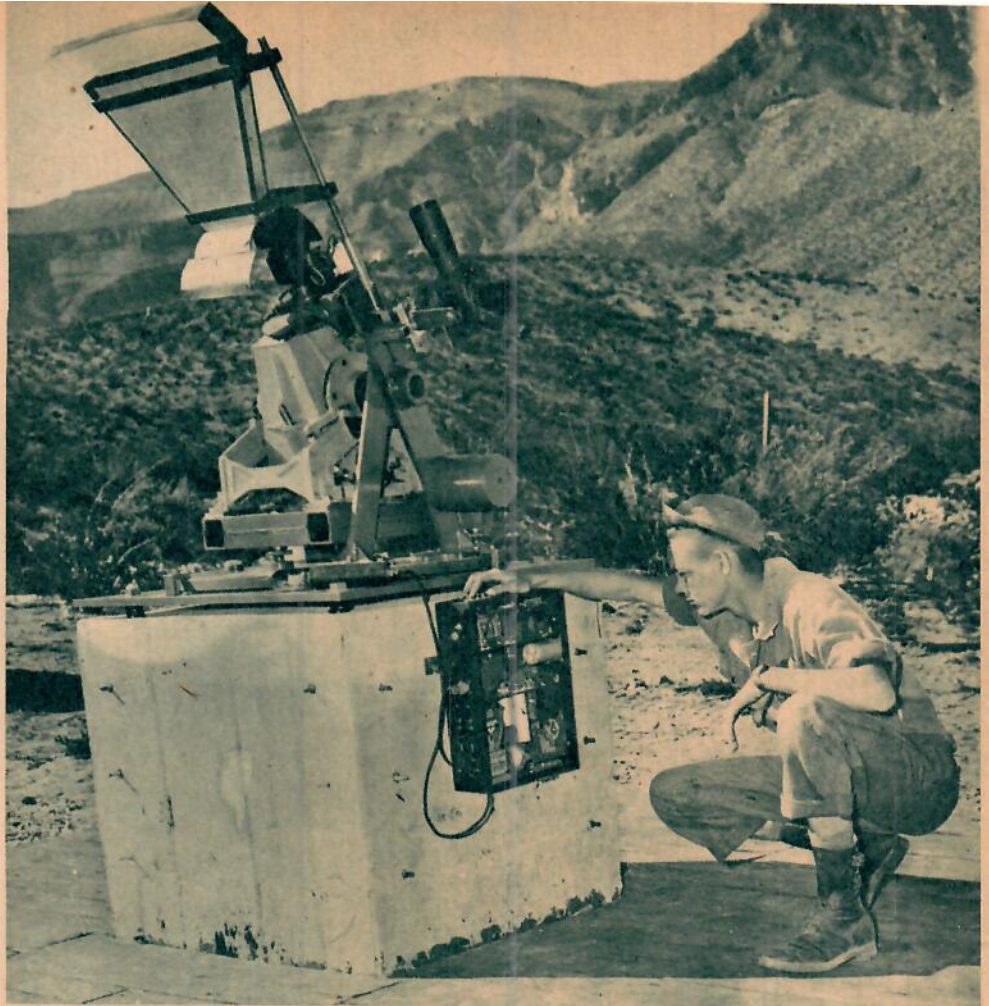
Kameran, instrumentets centrala parti, ser ut som en stympad, fyrsidig pyramid. Exponeringstiden är en 150-dels sekund, objektivets öppning 5 cm och brännvidden 30 cm.
