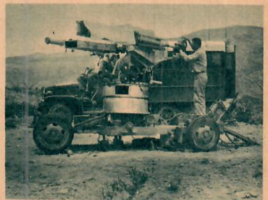
Flyttbara kameror förekommer också. Här ses en filmkamerastation monterad på en bil.
