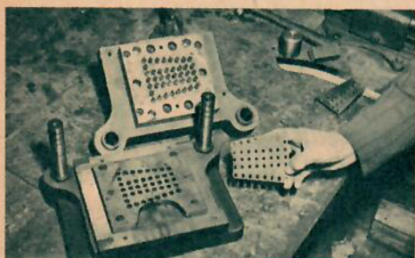
Trycket på verktyget som pressar alla hålen i de s. k. sektorplattorna är ungefär 40 ton.
