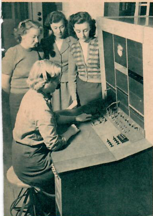
En grupp blivande telegrafister får öva sig i att använda ett modernt riksbord med snedmultipel. Med knappatsen t. h. går det för övade telefonister nära dubbelt så fort som med den långsamma fingerskivan.
