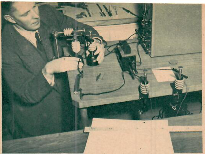
Magister K. Sander i Ängby läroverk med en ny märklig byggsats med vilken man kan demonstrera åtskilliga elektriska och radiotekniska fenomen. Här kopplar han upp en anordning som på katodstråleoscillografens skärm visar förhållandet mellan primär- och sekundärspänningarna vid en transformator. En av de få nyheterna.
