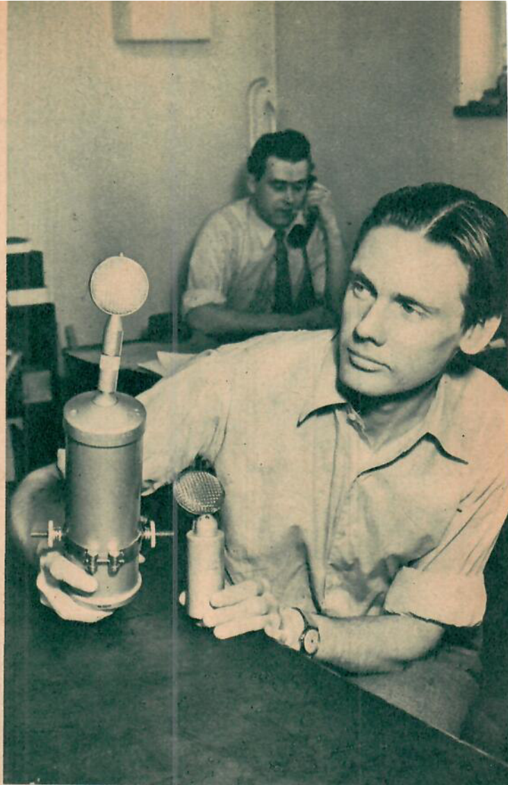
Civilingenjör Lennart Ljungberg med en kondensatormikrofon av den gamla 3-kilostypen i högra handen och en ny revolutionerande liten mikrofon som väger endast 300 gram i den vänstra handen.
