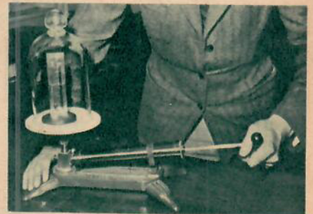
Fortfarande köper skolorna den här gamla klassiska kolvlufftpumpen med vilken man kan göra försök med lufttryck och vakuum.
