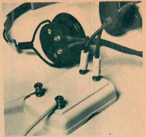
Detta är hela radion. T. v. antenn- och jorduttag och t. h. uttag för de båda hörlurarna
