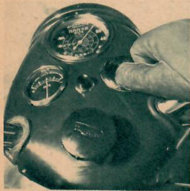
Hastighetsmätare med varvgradering, ampèremätare, kortslutningsknapp, elektrisk omkopplare till strålkastaren samt styrbroms, finns på strålkastaren.
