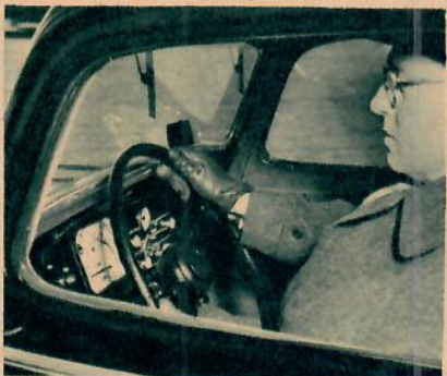
Stor, tvåkrad ratt ger god sikt över instrumentpanelen. Körställningen är utmärkt. God plats att sträcka ut benen.
