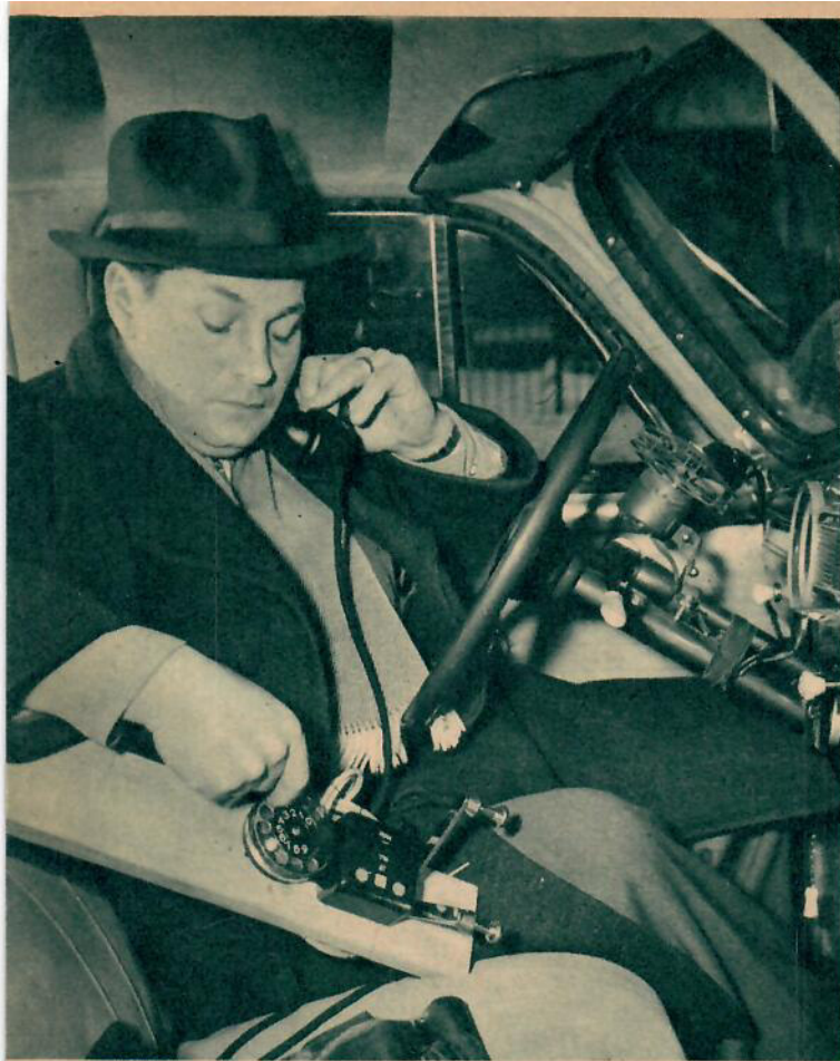
Telegrafist E. Eriksson vid telegrafstyrelsens radiobyrås provlaboratorium slår här ett nummer på fingerskivan, som ännu så länge endast är provisoriskt uppmonterad på en träplatta under försöken.
