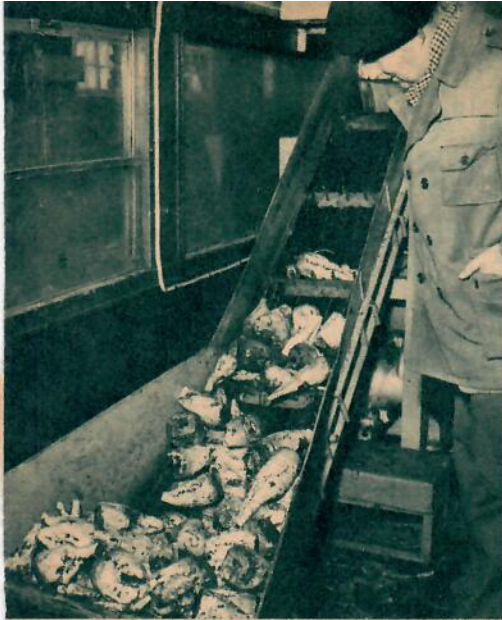
Sedan beterna tvättats och vägts går de på en transportbana in i bussen till skärning och sågning. Det är agronomen Leif Houmann, som övervakar den lilla proceduren.
