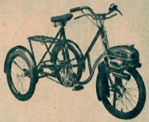
Flink saknar koppling och växel. Motorn driver på framhjulet.
