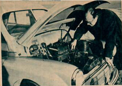
Motorn är liten i formatet och dess detaljer är lätt åtkomliga. Luftkanalerna för ventilationen är mycket ordentligt tilltagna.
