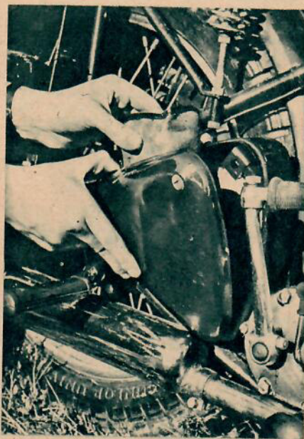
Så här mycket går verktygslådans lock att öppna! Låset måste öppnas med skrivmejsel!
