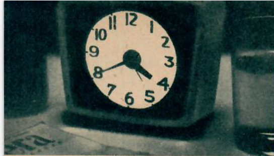
Den av »panelescerande» ljus upplysta urtavlan är betydligt bättre synlig än en vanlig självlysande och drar inte ens 1/25 watt.
