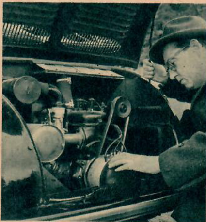
Tvåtaktsmotorn har ovanligt gott utrymme under bakluckan, åtkomligheten förebildlig.
