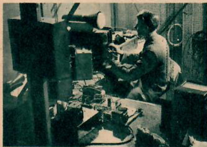
För den ingående kontrollen av ljudtrådens kvalitet har ing. Holger Frödén jordat ett provrum. Här mäts frekvensåtergivningsskurvan.
