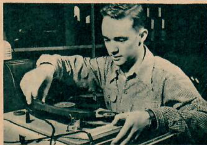
Rolf Ericsson gör lyssningsprov på den färdiga tråden, knyter samman tråden med en likare, noterar minsta kvalitetsskillnad.
