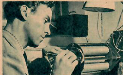
Arne Nilsson kopplar på impulser till magneterna på sekundärur. Viktigt: noggrannhet.
