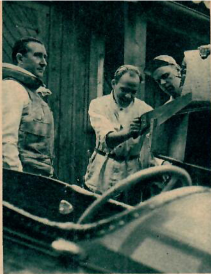
Första försöket i A-klassen misslyckades — motorn låg för högt och tog in luft. Mekanikerna Olle Bergkvist och Hilding Löf justerade snabbt den detaljen med en såg.
