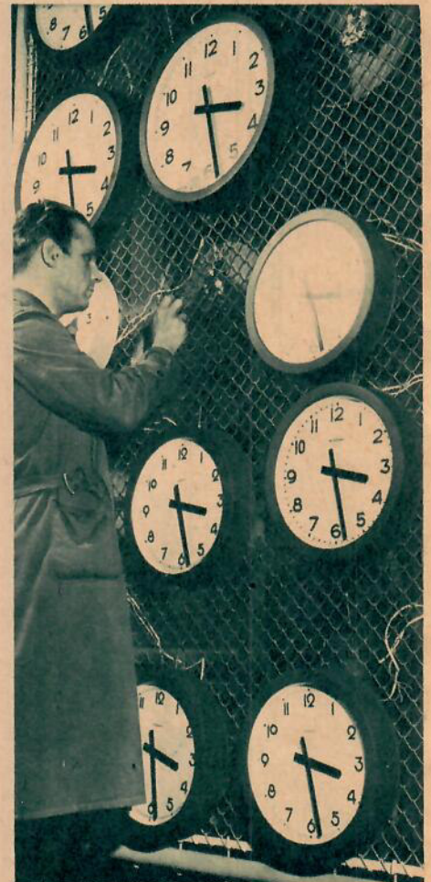
Arvo Rantanen kopplar sekundärur för prov i laboratoriet, där varje ur kontrolleras.
