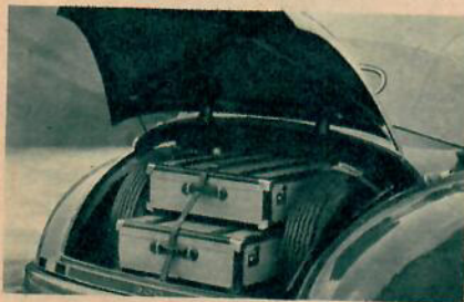
Välplanerat utrymme för långresor. De för vagnen speciellt dimensionerade väskorna betyder bästa möjliga utnyttjande av bagagerummet. Vid behov kan man få en särskild hållare för ena reservhjulet på utsidan.
