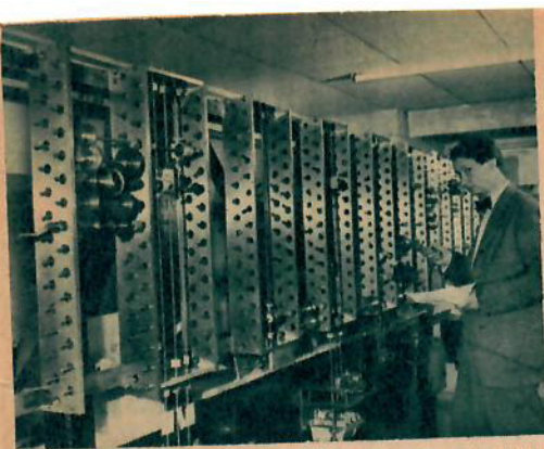
Så kopplas ett invecklat problem upp. Civilingenjör Björn Lundquist vid den mekaniska differentialanalysator som han byggt tillsammans med professor Stig Ekelöf.
