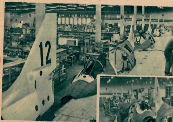
För att underlätta monteringsarbetet har man byggt en speciell brygga som möjliggör monteringsarbete i »två våningar». I motsats till slutmonteringen går denna linje »kräftgång».
