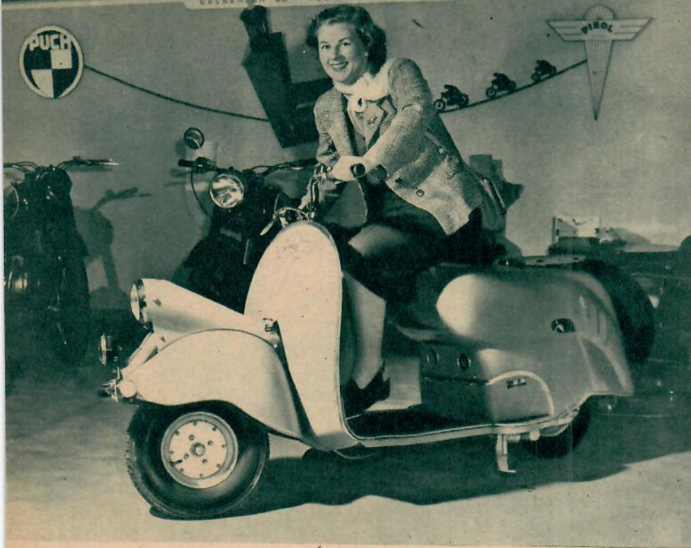
En tysk scooternyhet är Pirol med 200-kubiks motor. Den är klumpigare än t. ex. Vespa men så utvecklade motorn också 6,5 hk vid 4.500 v/m. Växellådan är fyrväxlad. Vikt 96 kg. Framhjulet har torsionsfjädring och i standardutrustningen ingår bl. a. hastighetsmätare.
