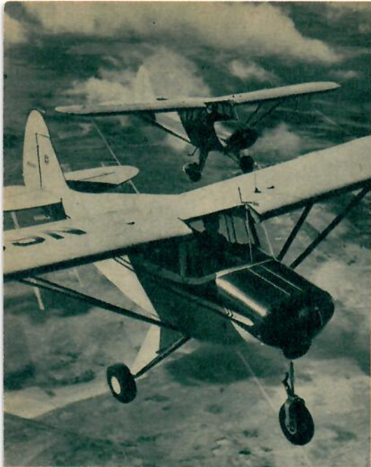
Piper Pacer och Tri-Pacer är exakt samma flygplan med undantag av landstället. På grund av noshjulsstället har Tri-Pacer något högre tomvikt och 5 km/t lägre fart.
