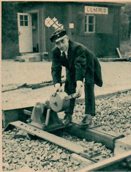
Det är inte länge sedan Anders Larsson fick lägga om växeln i Gilserud med handkraft — i ur och skur. Nu kan han tillåta sig sitta med armarna i kors. Växeln läggs automatiskt.
