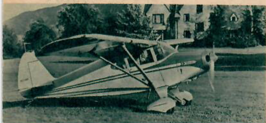
Piper Pacer är ett kompakt, robust plan, byggt för snabb och bekväm persontransport. Planet är 4-sitsigt och gör över 200 km/t.
