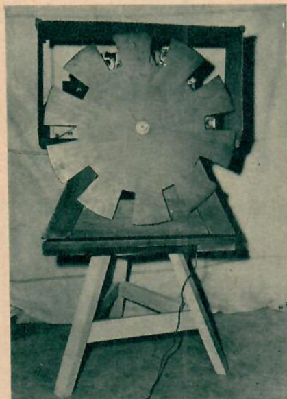
De många kamerorna har monterats innanför ett roterande hjul som är så konstruerat att det täcker linserna 10 ggr i sek.
