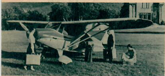
Förutom fyra personer tar Pacer 23 kg bagage. En stor dörr på vardera sidan underlättar av- och påstigning för passagerarna.
