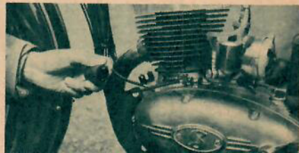
Skall man montera bort motorn ur ramen lossas hela det elektriska systemet genom en enda stötkontakt. Inga lösa sladdar.
