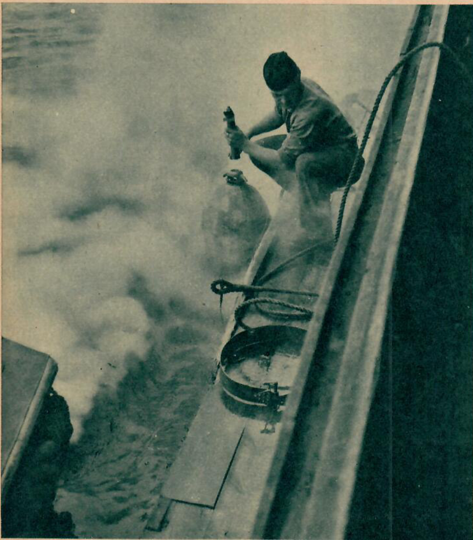
4 Bärgningsbåten har ingen svårighet att hitta torpeden när den gått distansen ut. Här plockas det kalciumljus bort som finns i torpedens spets och som börjar ryka vid ytan.
