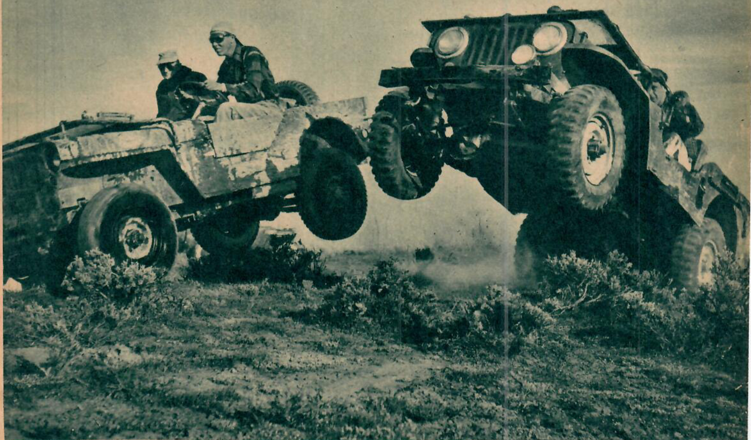
EN GROP I MARKEN GÖR ATT JEEPEN TAR ETT JÄTTESKUTT UPP I LUFTEN. FORDONEN UTSÄTTS FÖR VALDSAMMA PAFRESTNINGAR OCH HÅLLER INTE HELLER SÅ LÄNGE. EXTRA STORA DÄCK HAR MONTERATS PÅ FÖR ATT KLARA STÖTARNA.
