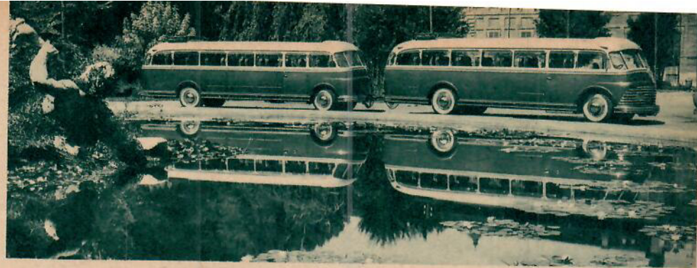
En av Viberti-fabrikens många flotta vagnar i vacker omgivning. Denna turistbuss med trailer har vunnit första priset i en »skönhetsävling» i San Remo. Såväl fram- som bakhjulen på trailern är styrbara, vilket gör att den följer exakt i dragvagnens hjulspår. En unik skönhet.
