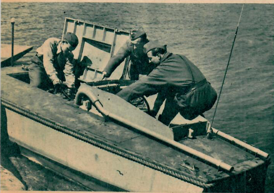
Motorn är en vanlig 100 hästars Ford marinmotor med radiostyrningstilläts. Båten är byggd så att den också kan framföras med en förare. T. h. styrapparatens antenn.
