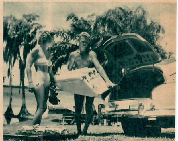
Större är inte den motoriserade surfingbrädan än att den ledigt får plats i bagageutrymmet på en bil. Lätt är den också, den väger bara 55 kg och det med motor.
