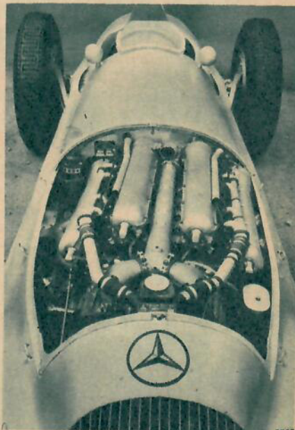
Den berömda treliters Mercedesracern. Motorn sitter en smula snett i vagnen så att kardanaxeln kan passera i höjd med förarens höft. Förarstolen sitter lågt och åt höger.
