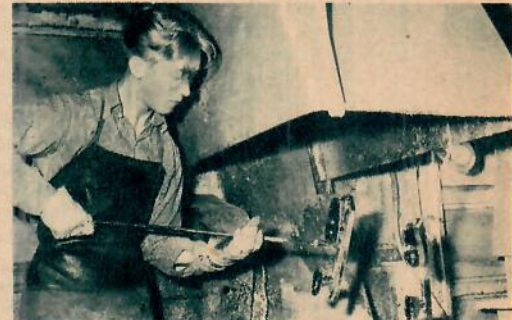
Trots att det är mitt i sommaren är ändå tillverkningen av skridskor i full gång. Ungefär 100.000 par hinner man med per säsong. Varje skena hårdhetsprovas med intryck med diamantkon och varje skridsko doppas i ett 250-gradigt tennbad av Ake Andersson så att den får sitt glänsande utseende.
