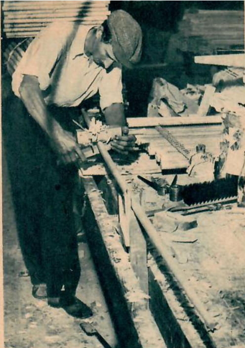
Svarvning av spjut fordrar mycket stor yrkesskicklighet. Det absolut kvistfria och raka björkvirket får sin rätta form av Rune Johansson med hjälp av en hyvel och svarv.
