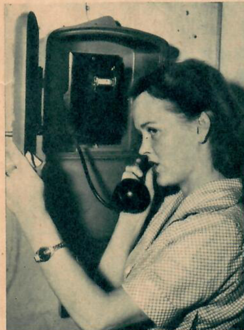
Gammalt och nytt — det nya kommer i hela landet, och idén är Malmös. För att komma åt handtaget i de gamla skåpen måste en glasruta krossas. Inga upplysningar kunde lämnas brandkåren. Nu blir det direkttelefon som fyller sin uppgift även om den skulle användas av en dövtum. På brandstationen blir det nämligen larm i och med det att luren lyftes.
