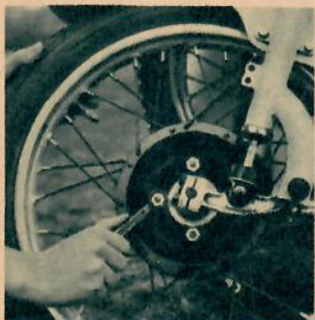
Att byta hjul på Galletto är en barnlek. På framhjulet behöver man bara lossa på fyra bultar.
