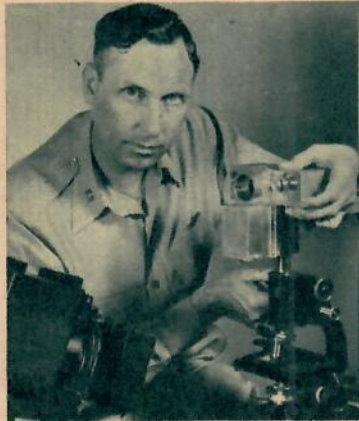
Detta kallas för fotomikrografi: Kameran sitter på ett mikroskop.
