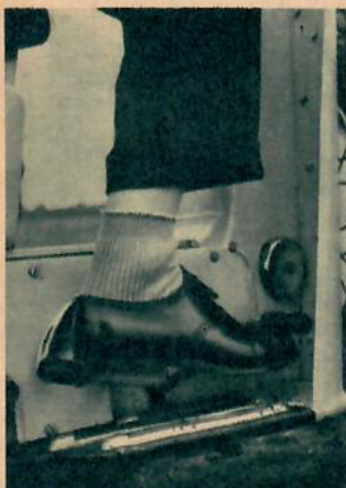
Den här bilden visar att foten inte kan sättas ner direkt på fotbrädan utan måste saxas därför att fotväxeln är för kort.
