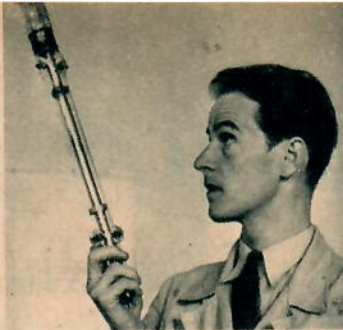
Ett elektronvåg rör för våglängd med en handbredd som skulle innebära att 100.000 telefonsamtal samtidigt kan förstärkas av röret.
