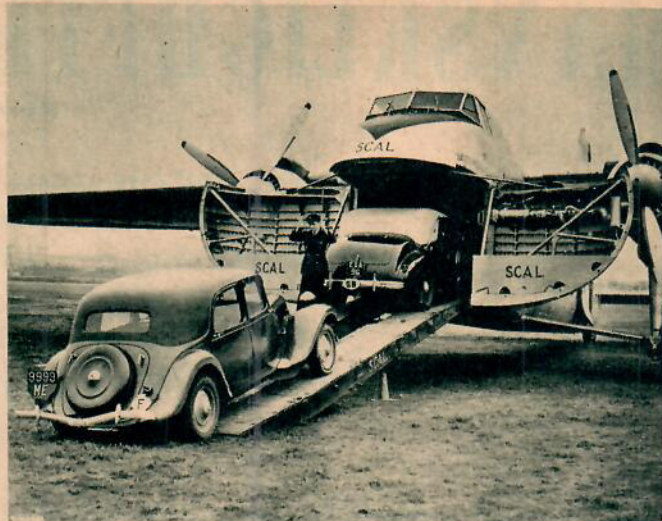
Bilarna körs direkt upp i Bristolplanet efter ankomsten till Lympne, där de dirigeras upp i flygplanet av flygpersonalen. Precis som på båt.
