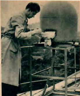
»Plåtburken» som på bilden kontrolleras av civilingenjör Gösta Hellgren är en antenn-anläggning för 3 cm radar.
