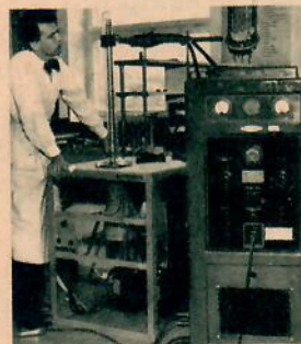
Civ.-ing. Lars Stelling håller på med lödning med hjälp av en högfrekvensugn. Till kopparslingan runt glasröret matas en effekt av inte mindre än 10 kilowatt.
