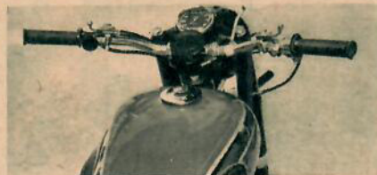
Styrstangen är kanske i längsta laget för att sitta på en sportmaskin, men den ger oenkligen ganska bekväm körställning. Hastighetsmätaren sitter inmont. i gaffelhuvudet.
