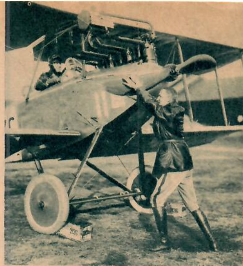
När flyget var ungt existerade inga startmotorer. Mekanikern fick dra i gång motorn.
