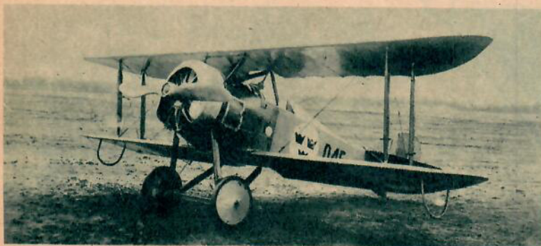
Tummelisa, eller Tummeliten som den också kallades, var flygkompaniets största förbrukningsartikel på 20-talet. Kärran var så känslig på rodrer att flygningen mest liknade balansgång på slak lina. Tummelisa var 7,8 m lång, drevs av en 9-cylindrig roterande motor och hade en maxhastighet på 150 km/t.
