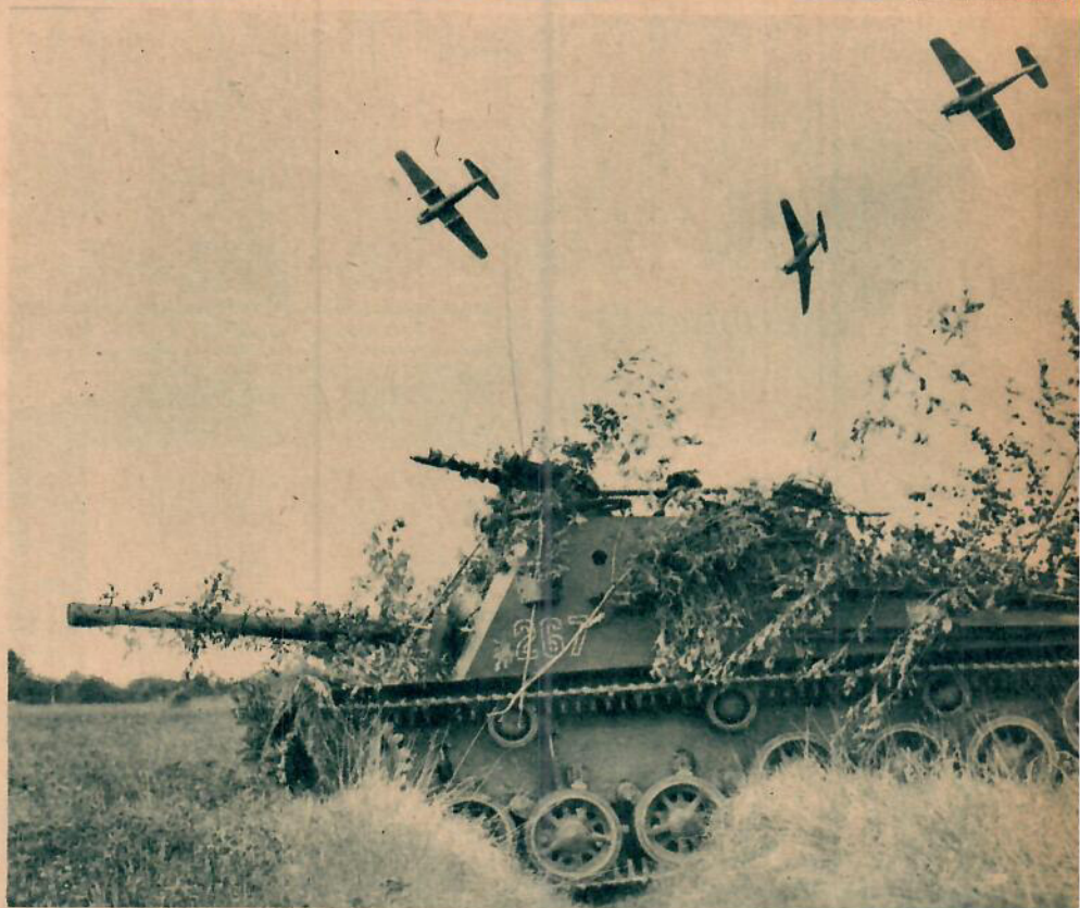
En svensk pansarvärnsskanonvagn modell 43 får här eldunderstöd av tre B 17. Pansarvagnen är bestyckad med en 7,5 cm kanon och en 8 mm Ivkulspruta. Flyget ökar eldkraften.
