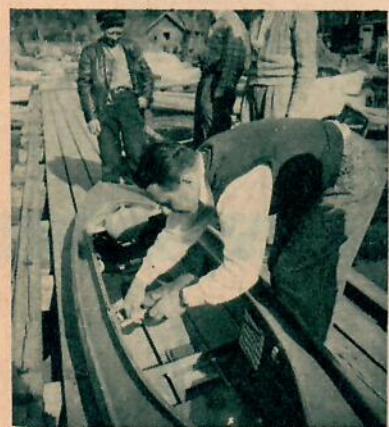
7 Ett stag tvärsöver sittbrunnen ger säkert ryggstöd åt den som sitter längst fram. Och så är kanoten färdigmonterad.
