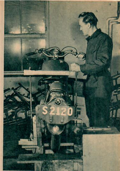
Ingenjör Folke Mannerstedts »fartbänk» där man kontrollerar maskinernas fartresurser.
