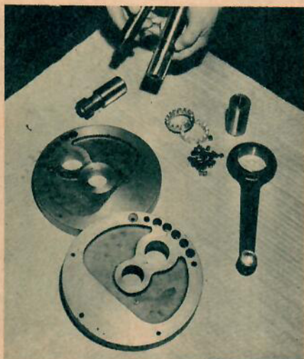
Vevpartiet på Union är betydligt kraftigare än på Monark m/42. Ing. Mannerstedt visar fram den gamla vevtappen i högra handen och den nya i den vänstra. Även vevstaken och rullagera är nu betydligt kraftigare.
