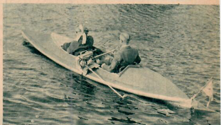
10 Tröttnar man på att segla och paddla kan man använda den lilla kanotmotorn, som lätt kan ändras till cykelpåhängsmotor.
