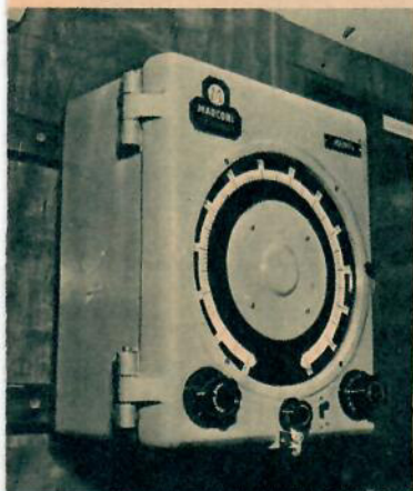
Ekolodets direktvisande apparat på vars skala vattendjupet indikeras i endera fot eller famnar.
