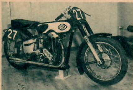
Den här maskinen väntar många TT-entusaster på! Motorn är en 350-SRM och tanken liknar en gammal HVA-tank från den gamla goda tiden. Union skall med denna modell tagit upp Husqvarnas fallna racermantel.
