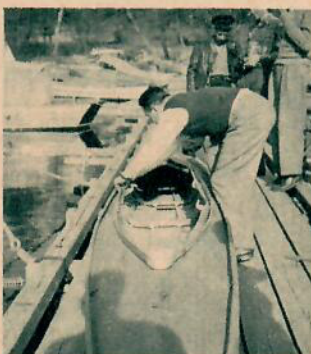
6 Stagen kring den stora sittbrunnen måste sitta stadigt och speciell uppmärksamhet läggs ner på att de fästs noga.
