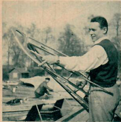
3 För- och akterstävorna är gjorda som sammanhängande enheter men de mindre spanten sätts på genom hakar.
