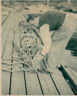
2 Ur väskorna plockar man ut en samling lösa spant, som man radar upp så att de på enklaste sätt kan monteras ihop.
