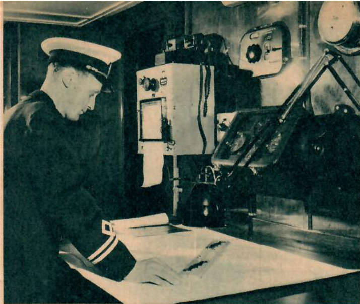
Andrestyrman S. Appelgren framför det modernaste av »Patricias» navigeringsinstrument — Deckaapparaten — som med hjälp av från landstationen utsända radioimpulser ger automatisk positionsbestämning. Instrumenten i den svarta lådan t. h. indikerar positionen. Sjökortet på bordet är ett speciellt Deckakort med hyperbelrutnät.
