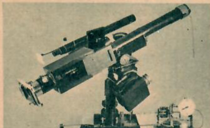
Här ses den hemmagjorda kikaren monterad för sol- och månfotografering med okularförstoring. Framför kikaren sitter urverket, som driver den och således möjliggör kontinuerlig följning av himlavalvets rörelser.
