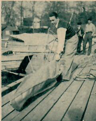
4 När stommen börjar bli färdigmonterad träs den in i kanotduken, som är en med skoningar förstärkt segeldukspåse.
