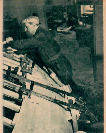
3 Borden tvingas ner i form vid limningen som sker med engelskt lim, Celloband.
