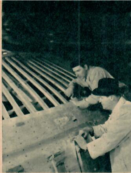
2 Efter limningen skruvas borden till spanten som på denna typ ligger i solfjäderform.
