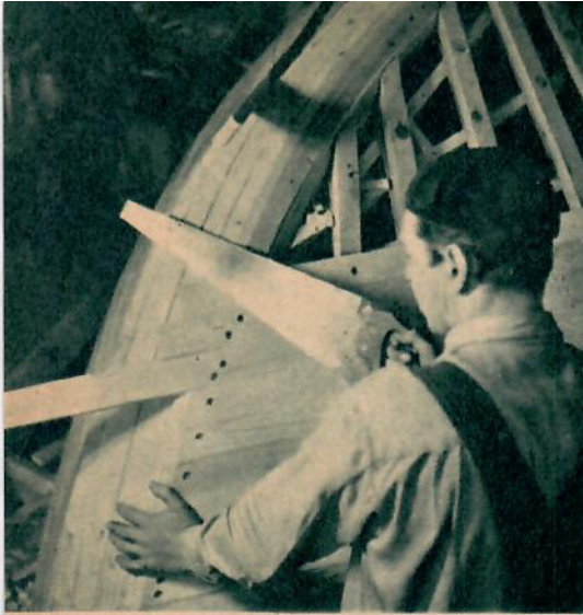
1 Borden ansluts till innerstaven och sågas av varefter ytterstaven limmas fast och putsas.
