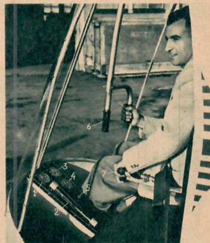
Manövreringen är enkel. Här är alla instrument och pedaler: 1) varvräknare, 2) bränsletillförsel-skvallerrör, 3) hastighetsmätare, 4) höjdmätare, 5) startknapp, 6) spak för färdriktning och 7) kombinerat stig- och gasreglage som sitter på sidroderspaken.
