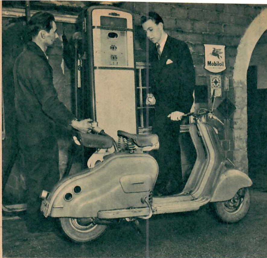
Bensinpåfyllningshålet är lätt åtkomligt. Normalt behöver det inte allt för ofta komma i kontakt med en bensinlang eftersom Lambretta går närmare 5 mil på en liter och tanken rymmer dryga sex liter. Förgasaren kommer man åt genom den lilla luckan på karosseridan.
