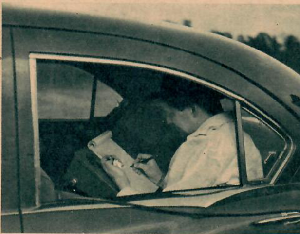
Med hjälp av hastighetsmätaren och stoppur kontrolleras vagnens acceleration, verkliga fart etc. Kontrollanten sitter i baksätet och för ett noggrant portokoll över resultaten av proven.
