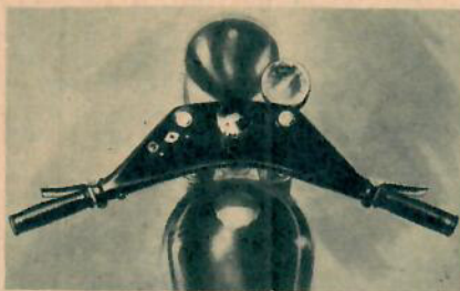
Nimbus' säregna styrstäng i vilken finns monterat diverse instrument som laddnings-lampa, startnyckel och styrbroms. Stängens är anmärkningsvärt fri från lösa kablar o. dyl.
