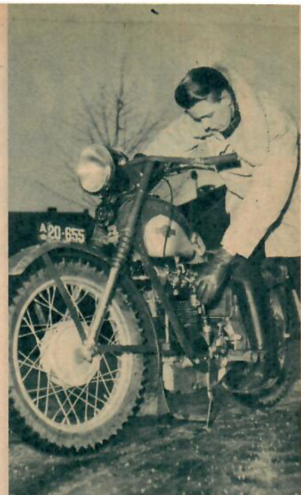
Förgasaren behöver flödas endast då motorn blivit kall. Kickstarten går »på tvåren».
