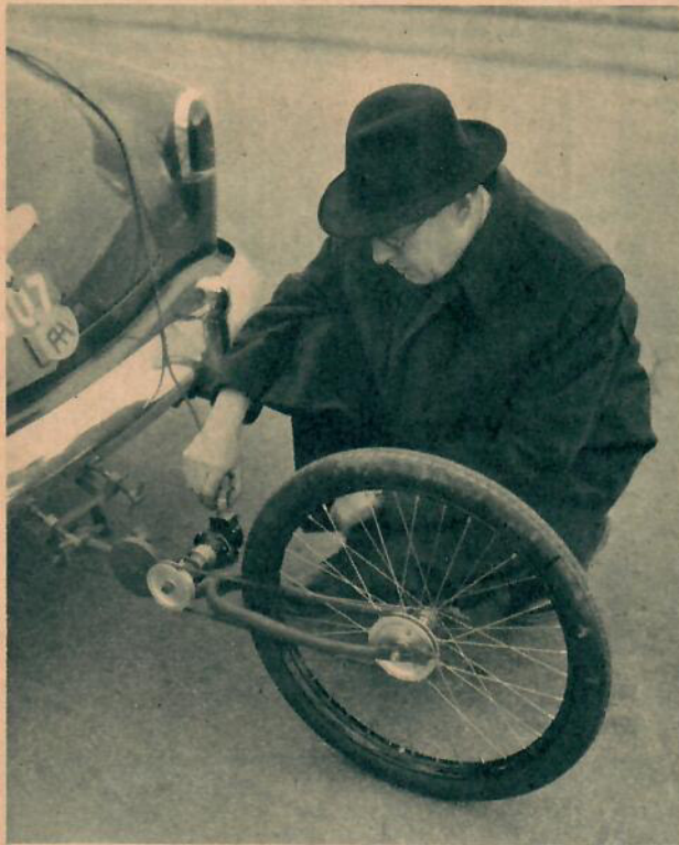
TV:s bilexpert, civilingenjör Bertil Björkman kontrollerar kabeln till generatorn på den nya elektriska hastighetsmätaren som nyligen med gott resultat tagits i bruk vid bilprovningarna.
