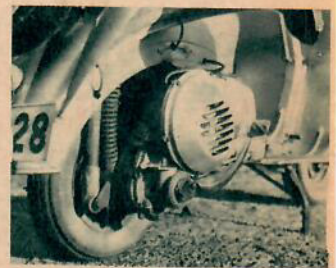
Motor och kickstartanordning samt fjäderingen sedd bakifrån.
