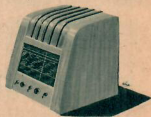
Ett förslag till inbyggnad: högtalaren placeras vågrätt ovanpå mottagaren.
