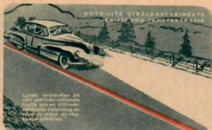
Strålkastare, avsedda för vänstertrafik, skal lysa nedåt och snett till vänster när man skiftar om från helljus till halvljus.
