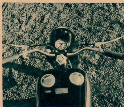
Hastighetsmätaren är som på andra tyska maskiner inbyggd i strålkastaren. Lock för både bensin- och oljebehållare på tanken.
