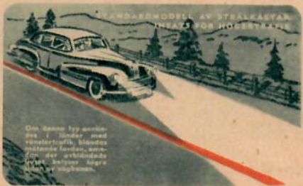
För högertrafik avsedda Scaled Beam-strålkastare riktar i stället ljusknippen åt höger mot den mötande som sålunda blir bländad.
