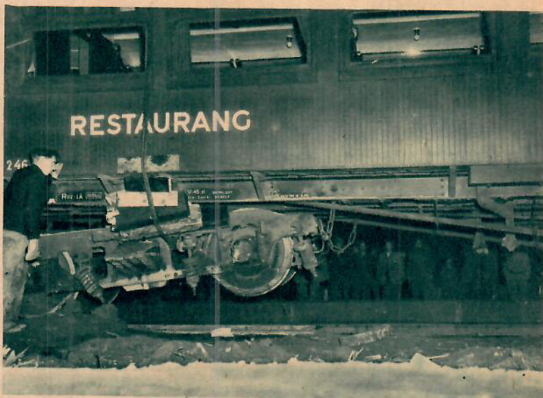
3 Några minuter senare har de båda kranarna flyttat sin 40-tonslast till det bredvidliggande spåret, varefter vagnen långsamt lyftes ned på detta. Hela proceduren tog 15 minuter. Klart för nästa vagn!
